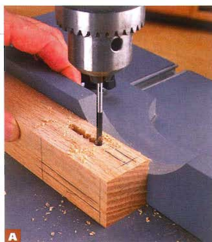
А Зажмите сверло Форстнера диаметром 6 мм в патроне сверлильного станка. Высверлите древесину в гнездах, используя упор для выравнивания отверстий в ножках.
