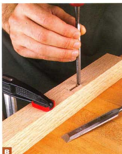
В Направляя стамеску перпендикулярно грани ножки, выравнивайте стенки гнезда и подравнивайте углы.
