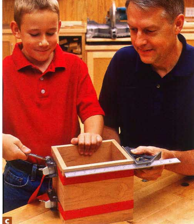
С Контролируя прямоугольность и плотность угловых стыков, стяните корпус двумя ленточными струбцинами.
