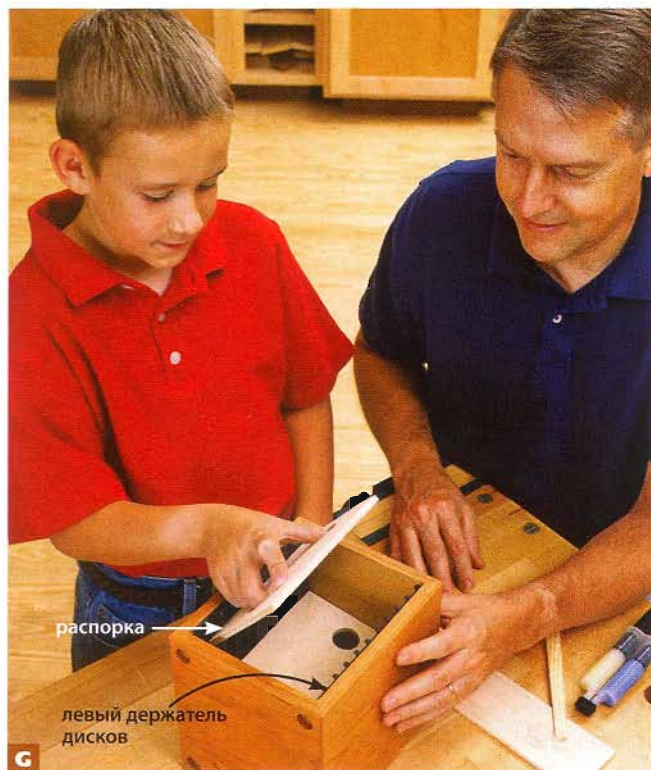
G Вставьте в корпус две распорки, одну сзади, а другую спереди, чтобы прижать смазанные клеем держатели дисков к боковым стенкам.
