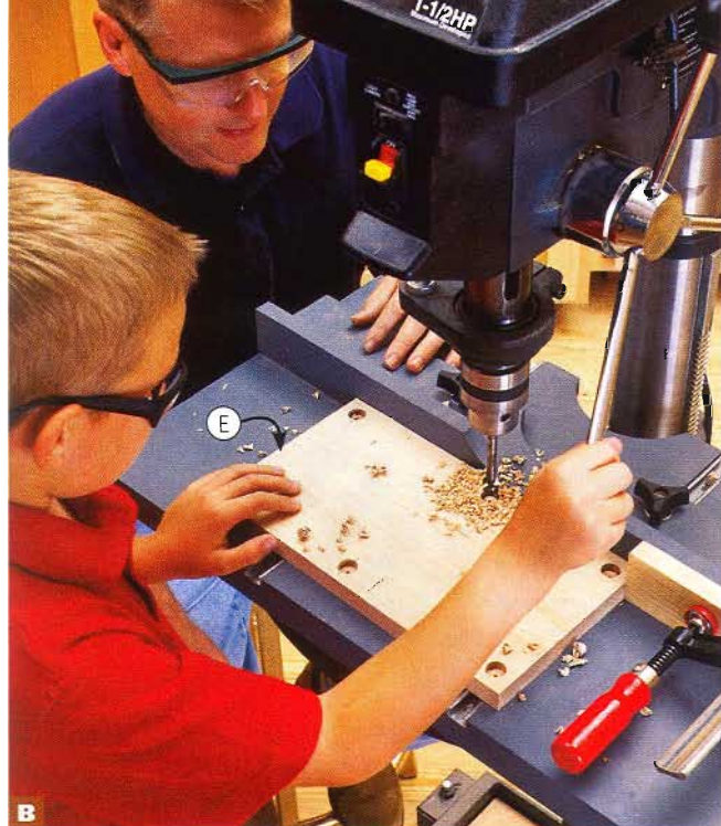
В Установив брусок-стопор на расстоянии 143 мм от оси сверла, просверлите отверстие в основании Е, затем поверните деталь на 180° и просверлите еще одно отверстие.
