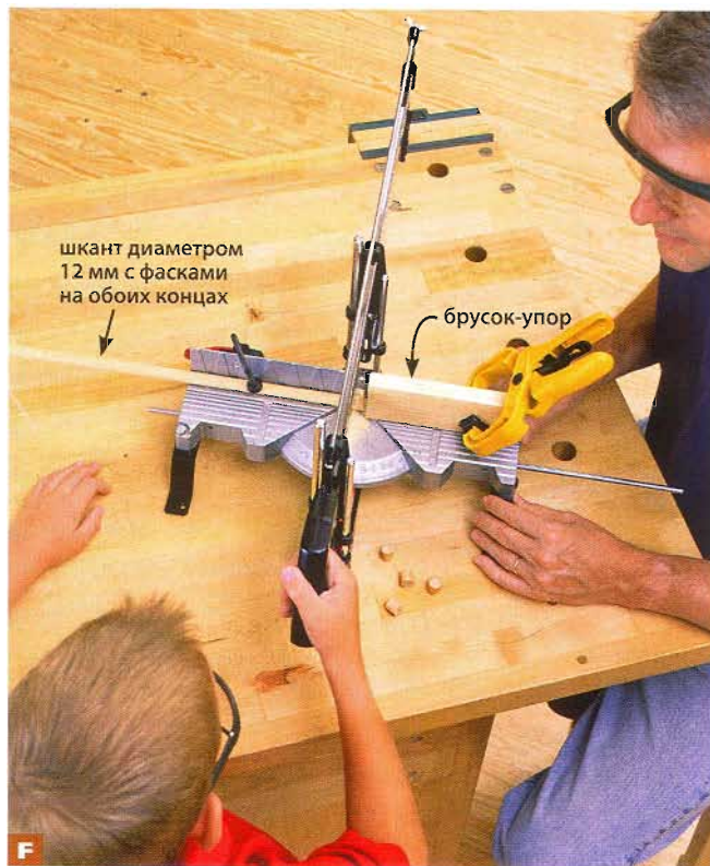
F Прикрепив струбциной к стуслу брус-упор, отпилийте от шканта со снятыми фасками ножки длиной 12 мм.
