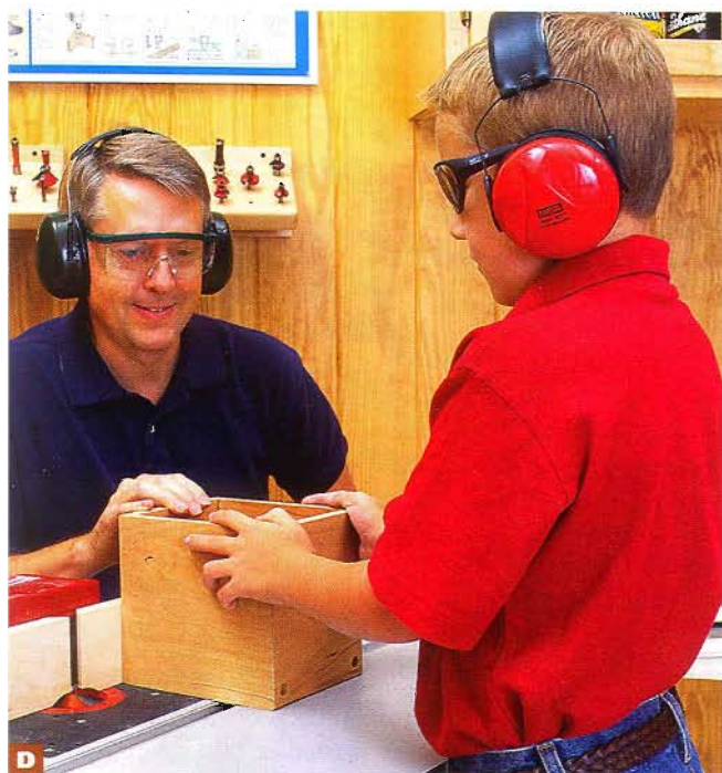
Д Чтобы сделать фаски на ребрах собранного корпуса, прижмите его к параллельному упору и плавно подавайте на фрезу.
